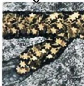
Kristallointiaine on pysyvästi täyttänyt betonin huokoskanavat
